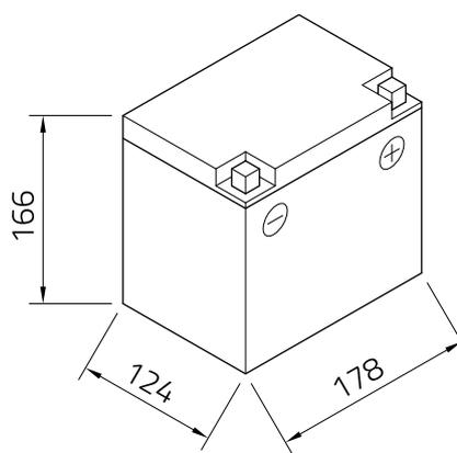
**Technologie** Verschlossene AGM (Elektrolyt in Glasfaser-Vlies gebunden) | gefüllt und geladen | absolut wartungsfrei
